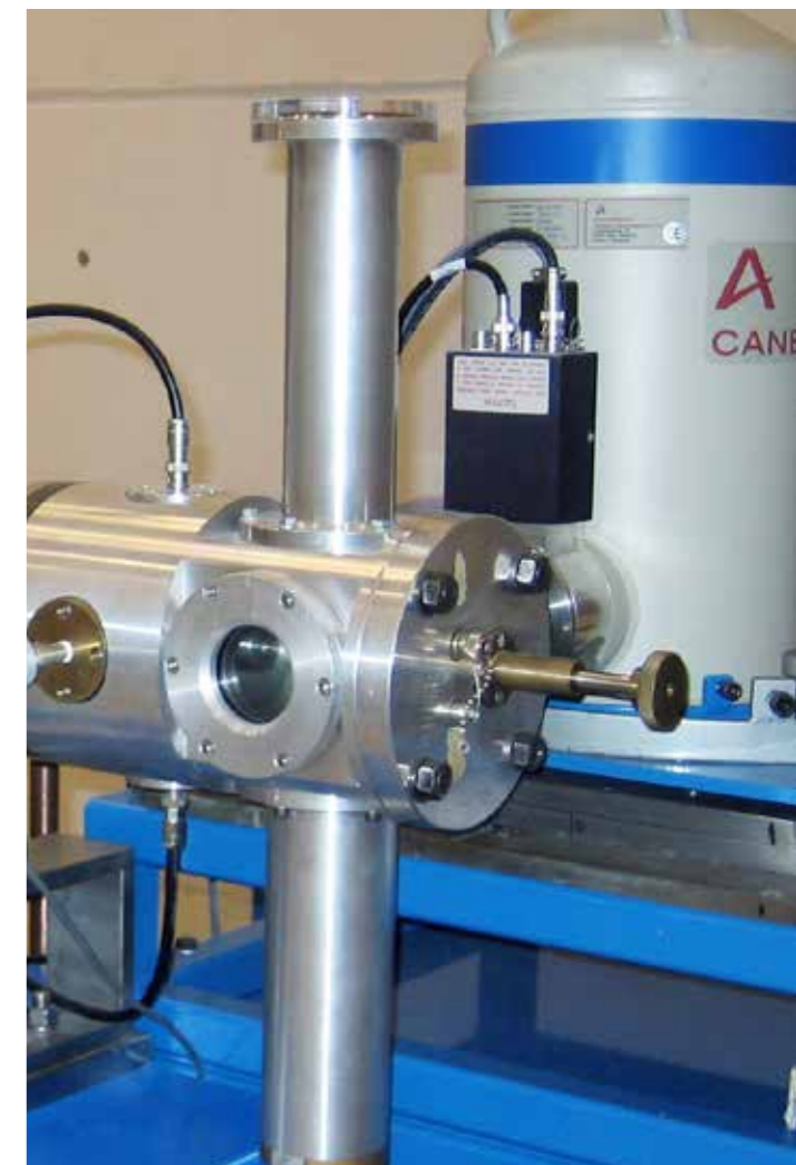
Cámara de irradiación. En este dispositivo las muestras que contienen el polvo atmosférico, se irradian con el haz de protones que proviene del acelerador de partículas.
