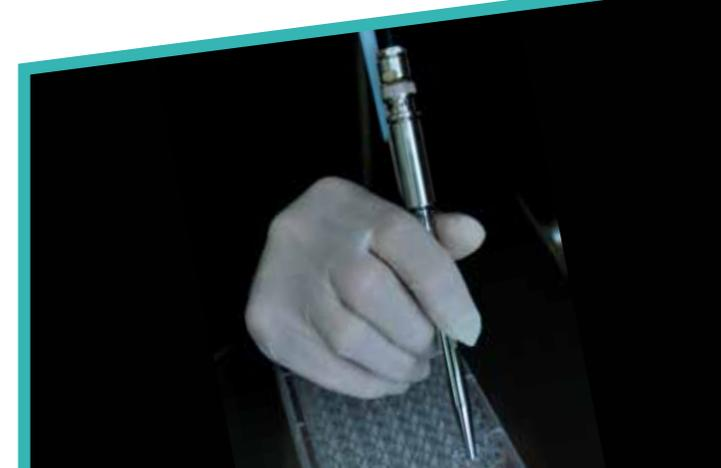
Modelo industrial de reactor para aplicación puntual de plasma no térmico a presión atmosférica.
