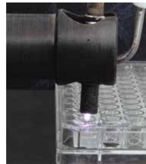
Aplicación de plasma de tipo aguja en helio a un pocillo de microplaca. Este tipo de experimentos son algunos de los que se realizan con microorganismos y células contenidos en un medio líquido.
