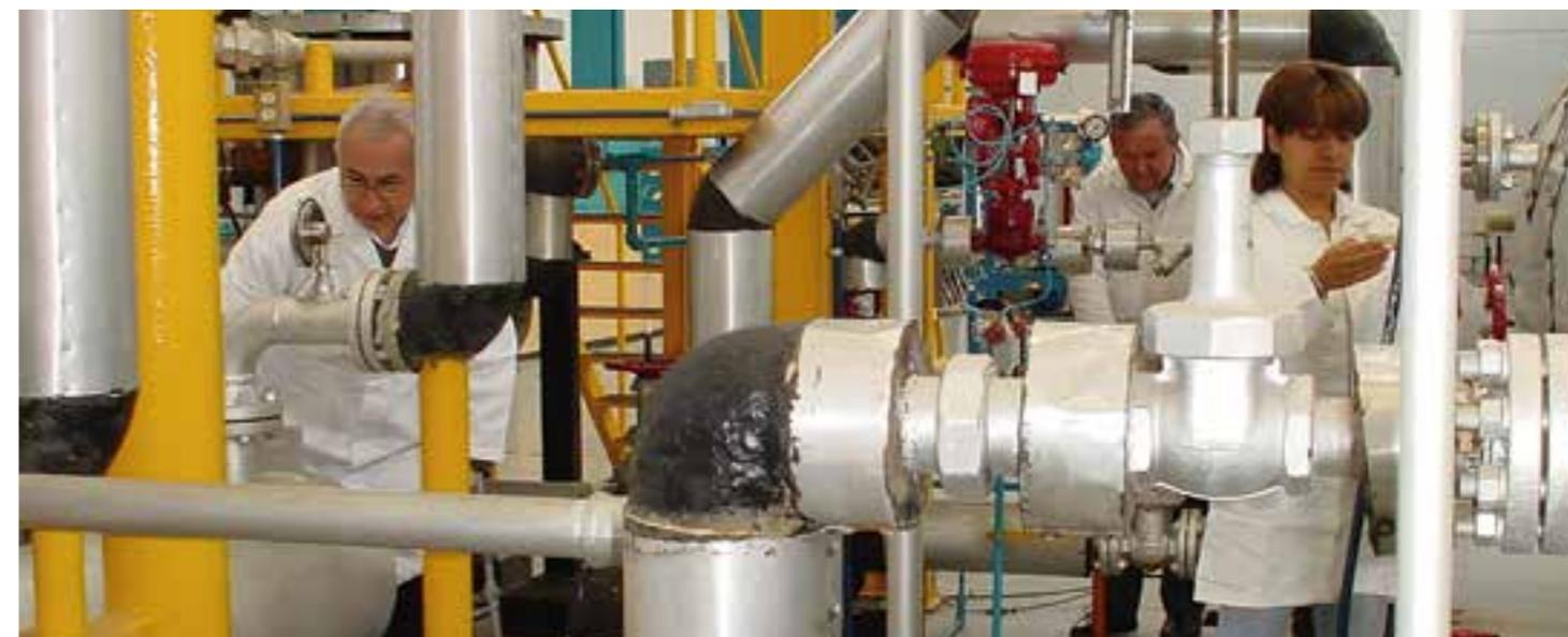
Inspección de instalaciones para pruebas con vapor sobre calentado para calificación de equipos con aplicación nuclear.
