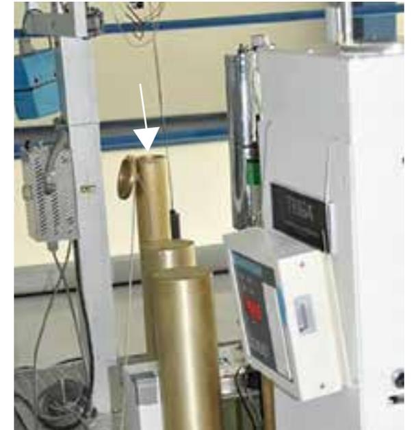
Tubo de acceso al SIRCA (Sistema de Irradiación Rotatorio de Cápsulas) donde se introducen las muestras de obsidiana para irradiarlas con neutrones.
