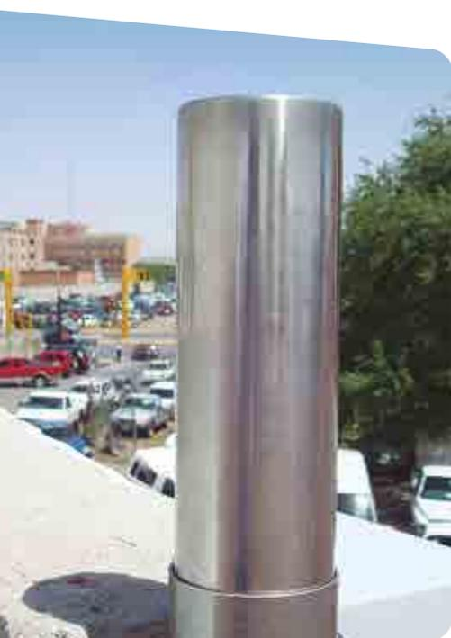
Exterior de la Sonda Monitor de Radiación Gamma (SMRG) instalada en Ciudad Juárez
